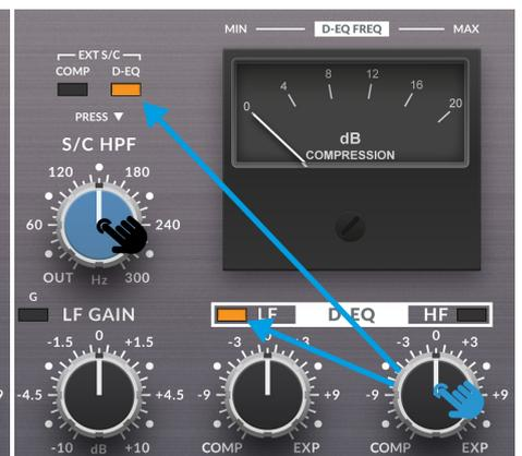
S/C HPF ポットを押したまま、D-EQ の HF ポットを押します。
