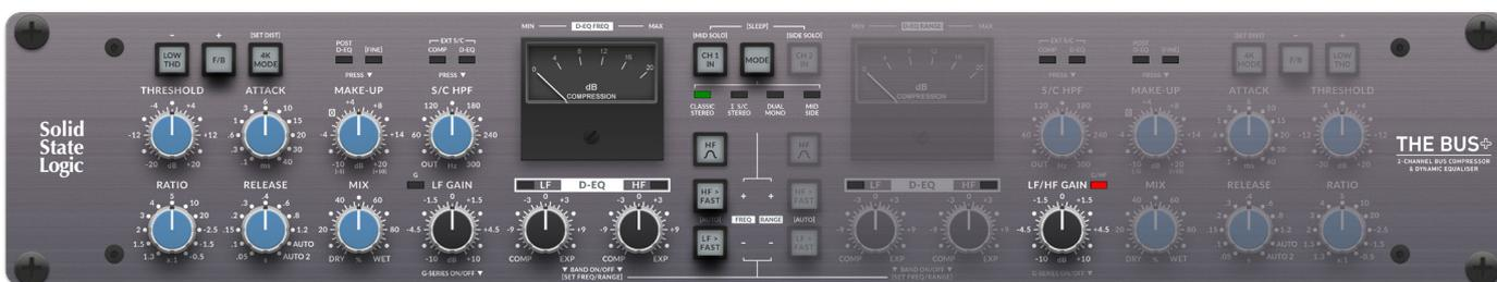
**CLASSIC STEREO** または  **$\Sigma$  S/C STEREO** モードでは、フロントパネル右側の **LF/HF GAIN** は **LEFT/RIGHT** 両側の **HF** ゲインコントロールとなります。この状態はポット近くの赤色 LED で表示されます。**DUAL MONO** または **MID SIDE** モードでは、**CH2** の **LF** ゲインコントロールとなります。つまり、**HF** ゲインは **STEREO** モード時しか機能しません。
