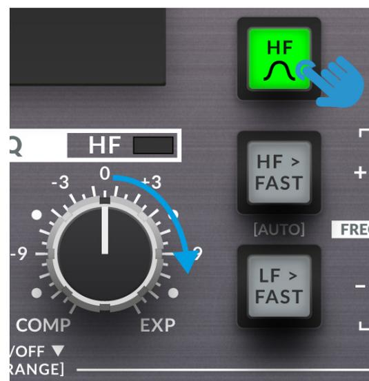
HF BELL スイッチを長押ししてトランジェント・エキスパンダー機能が動作します。HF コントロールを時計回りに回してエキスパンションをコントロールします。
