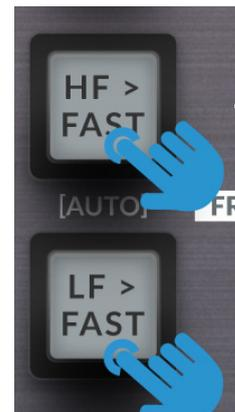
キャリブレーションモードに入るには、LF FAST と HF FAST スイッチ両方を押したままユニットの電源を入れます。
